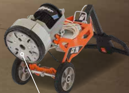
SCHNELLVERSCHLUSS-SYSTEM FÜR WERKZEUGE
