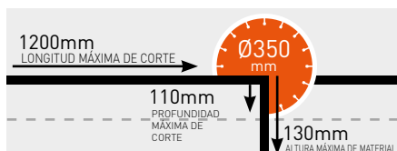
LONGITUD Y PROFUNDIDAD MÁXIMAS DE CORTE
