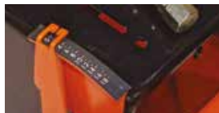
INDICADOR DE PROFUNDIDAD DE CORTE
