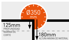
PROFUNDIDAD MÁXIMA DE CORTE
