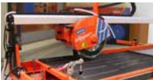
CABEZAL DE CORTE CON AMORTIGUADOR
