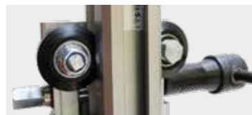
SISTEMA DE GUIADO DEL CARRO POR RODILLOS
