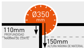
PROFUNDIDAD MÁXIMA DE CORTE
