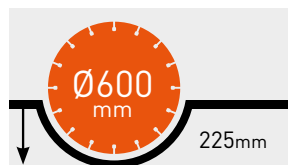
PROFUNDIDAD MÁXIMA DE CORTE
