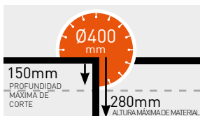
PROFUNDIDAD MÁXIMA DE CORTE
