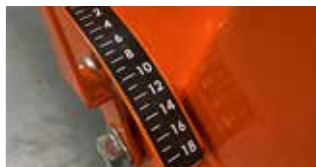
INDICADOR DE PROFUNDIDAD DE CORTE
