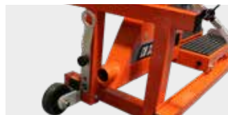
PUERTO DE EXTRACCIÓN DE POLVO Ø 40mm
