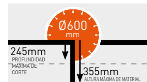
PROFUNDIDAD MÁXIMA DE CORTE - Ø600
