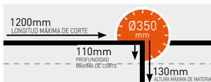
PROFUNDIDAD MÁXIMA DE CORTE - CST 120
