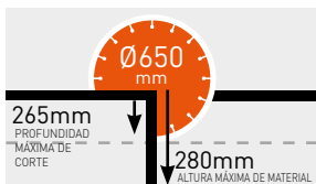
PROFUNDIDAD MÁXIMA DE CORTE
