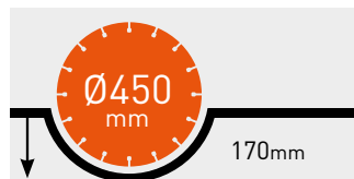
PROFUNDIDAD MÁXIMA DE CORTE
