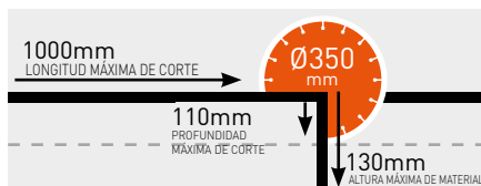
PROFUNDIDAD MÁXIMA DE CORTE - CST 100
