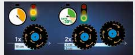
INDICADOR PATENTADO DE PROFUNDIDAD DE CORTE
