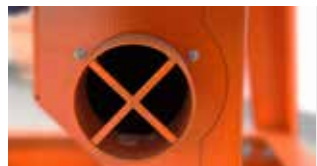
CONEXIÓN EXTRACCIÓN DE POLVO
