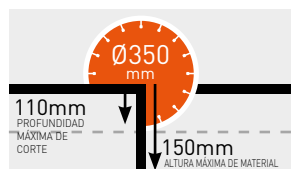
PROFUNDIDAD MÁXIMA DE CORTE
