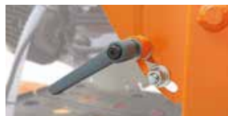
PEGA DE AJUSTE PROFUNDIDADE DE CORTE
