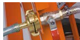
CONEXÃO DE MANGUEIRA DE ÁGUA
