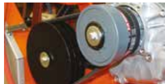
DISPOSITIVO DE EMBRAIAGEM AUTOMÁTICA (APENAS JUMBO P13)
