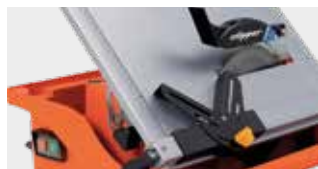
GUIA PARA BLOQUEAR O CORTE
