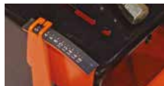
INDICADOR DE PROFUNDIDADE DE CORTE
