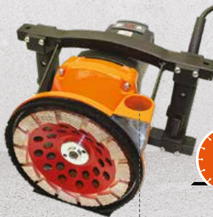
LIGAÇÃO DE TUBO PARA ASPIRADOR
