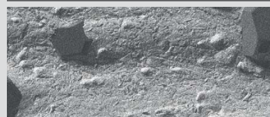
Herkömmliche Metallbindung: keine Porosität
