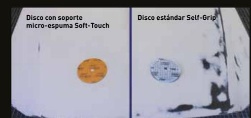
Obtén un lijado más uniforme y sin marcas en superficies y contornos. La micro-espuma Soft-Touch proporciona una rápida eliminación del efecto piel de naranja y un excelente acabado.
