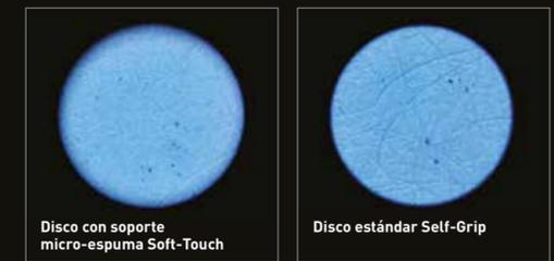
Los discos con soporte de espuma producen marcas menos profundas para un pulido más rápido y fácil.
