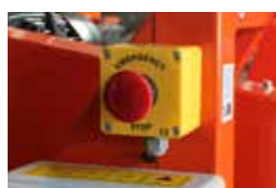
BOTÃO DE EMERGÊNCIA
