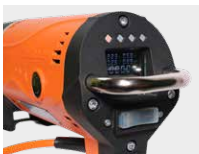
VISOR LCD E LED PARA MONITORIZAR A PERFURAÇÃO
