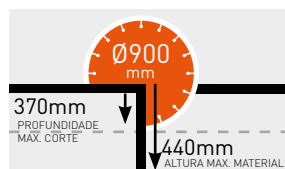
PROFUNDIDADE MÁX. CORTE Ø900mm
