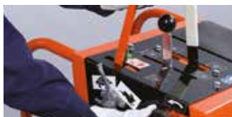
SUBIDA E DESCIDA DO DISCO MANUAL E HIDRÁULICA
