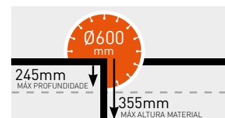
MÁX PROFUNDIDADE CORTE - Ø600
