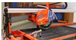
CABEÇA DE CORTE BASCULANTE
