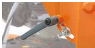
PEGA DE AJUSTE PROFUNDIDADE DE CORTE
