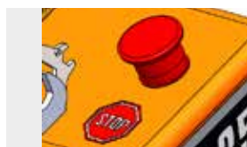
BOTÃO DE EMERGÊNCIA
