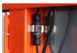
CONEXÃO FÁCIL BOMBA DE ÁGUA
