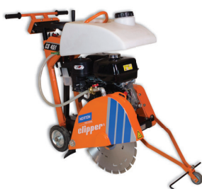
CS451 Honda GX390-13Hp Max Ø 450mm Max Prof. 170mm Avanzamento a spinta
