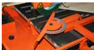
GUÍA DE CORTE CON AJUSTE ANGULAR
