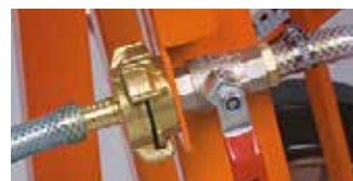
CONEXIÓN DE TOMA DE AGUA
