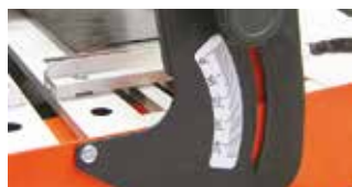
CABEZAL BASCULANTE (0 A 45°)
