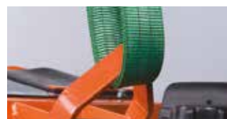
ARGOLLA DE ELEVACIÓN INCORPORADA
