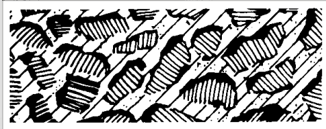
ESTRUCTURA ABIERTA (1/3 MENOS DE GRANO QUE EN LA ESTRUCTURA CERRADA)
