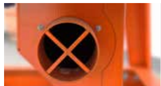
CONEXIÓN EXTRACCIÓN DE POLVO
