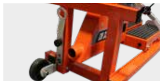
PUERTO DE EXTRACCIÓN DE POLVO Ø 40mm
