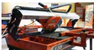
CABEZAL BASCULANTE (0 A 45°)
