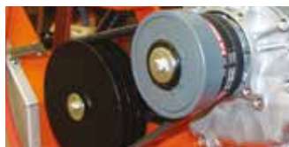
DISPOSITIVO DE EMBRAGE CENTRÍFUGO (SOLO JUMBO P13)
