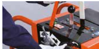
HYDRAULICZNE PODNOSZENIE I OBNIŻANIE TARCZY
