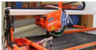
OPUSZCZANA GŁOWICA TNĄCA
