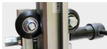
ROLKOWY UKŁAD PROWADZENIA ELEMENTU PRZESUWNEGO.
