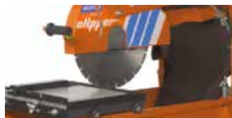
OSŁONA TARCZY ZAWSZE W POZYCJI POZIOMEJ
