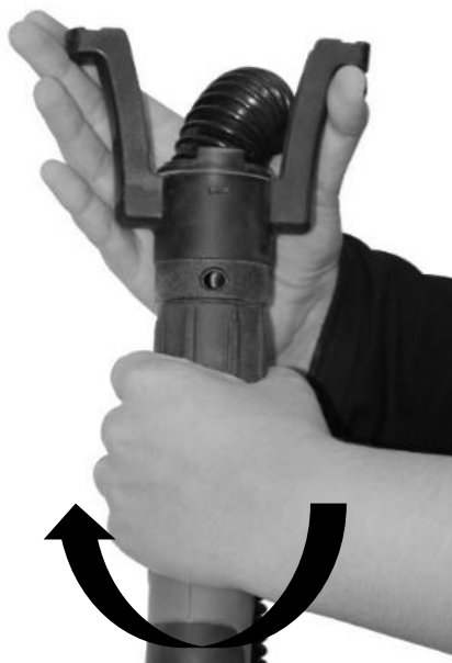
Figura 6 – Travando o sistema
