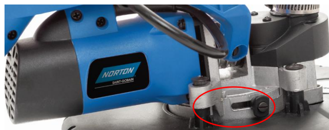
Figura 18 – Trava para substituição do suporte.
