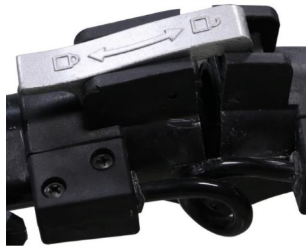
Figura 3 – Trabando el cable
