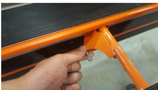
Gire el eje a 90 ° para bloquear la extensión lateral
