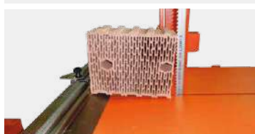
DISPOSITIVO INCLINATO PER IL TAGLIO VELOCE DEL POROTON
