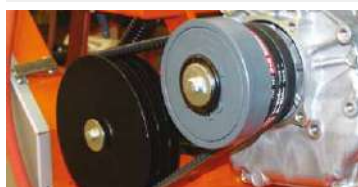
DISPOSITIVO CENTRIFUGALE SULLA FRIZIONE
