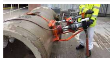
SEMPLICE FISSAGGIO SUI TUBI TRAMITE CINGHIE SPECIALI
