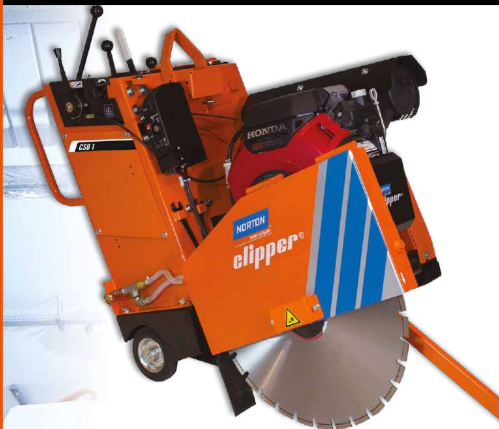
REGOLAZIONE PROFONDITÀ DISCO IDRAULICA O MANUALE
