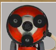
ADATTATORE IN VELCRO PER TAMPONI IN RESINA & NW FINISH E DISCHI PER LEVIGATURA
