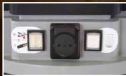
PRESA DI CORRENTE 2,4KW
