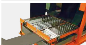
PARASPRUZZI E RACCOLTITORE ACQUA FRONTALE ESTRAIBILE
