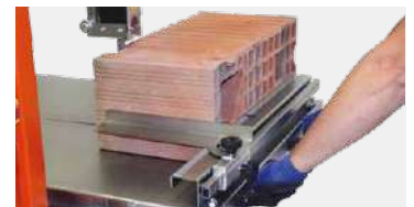
SPINTA MANUALE PER AVANZAMENTO
