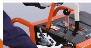
REGOLAZIONE PROFONDITÀ DISCO IDRAULICA O MANUALE
