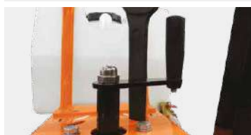
FACILE SISTEMA DI BLOCCAGGIO PROFONDITÀ DI TAGLIO
