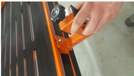
Beide Führungshalterungen einsetzen und mit Drehknöpfen sichern
