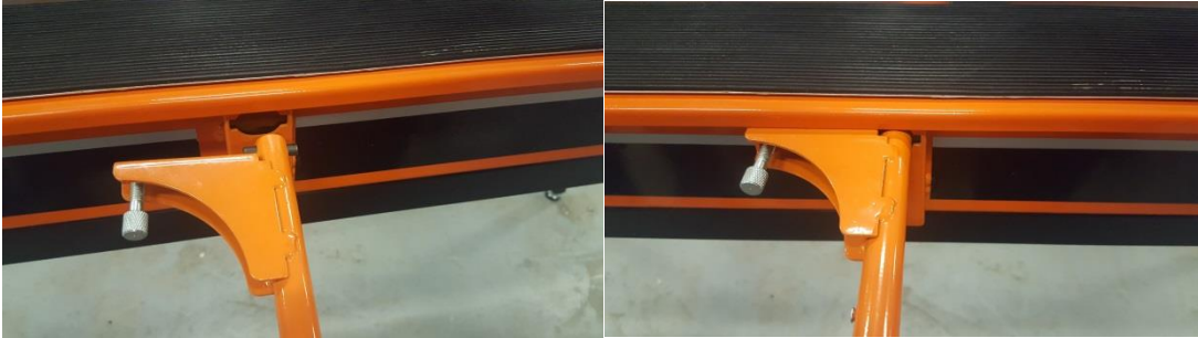
Beide Wellen mit Stift einsetzen
