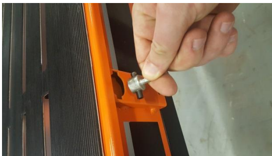
2 Gewindewellen mit Stift in die Öffnung einsetzen
