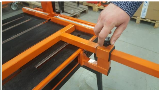
Die Schnittführung mit den Drehknöpfen sichern
