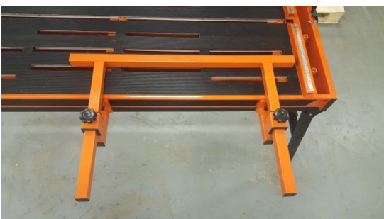
Die Schnittführung in beide Halterungen einsetzen
