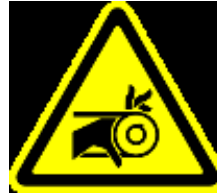
Einzugsgefahr durch offenen Riemenantrieb
