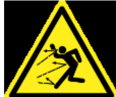
Gefahr durch herausgeschleuderte Teile
