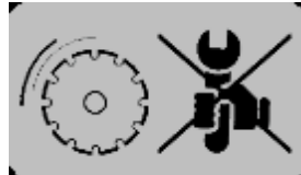
Interdiction d'effectuer la maintenance lorsque le moteur est en marche
