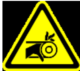
Risque de happement en cas d'ouverture de l'entraînement par courroie
