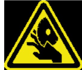
Risque de coupure et d'amputation dues à la rotation des outils de coupe
