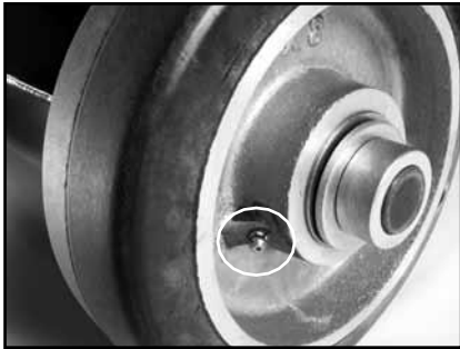
Zwei zerk Installationen auf vorderen LKW-Rädern
