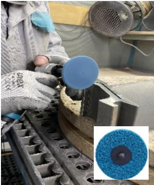
Adım 1: Norton Vortex 5AM ile çapak alma
