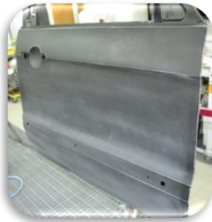
Dépolissage cataphorèse sur porte AV neuve avec CYCLONIC MULTI-AIR
