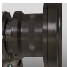
Głowica ukosująca z regulacją głębokości
