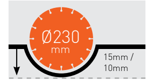
90° / 45°'de Maks. Kesim Derinliği 15mm / 10mm
