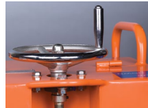
Sonsuz Vida Derinlik Kontrol Sistemine Sahip El Çarkı
