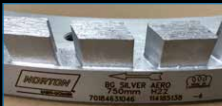
Figure 2 - Flèche gravée sur la bague de support en acier
