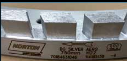
Abbildung 2 - Der eingravierte Pfeil im Grundkörper
