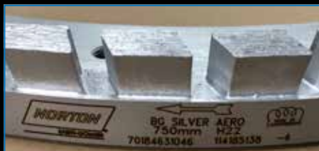
Obrázek 2 - Vyřtá šipka v ocelovém nosném prstenci
