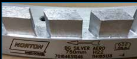
Rysunek 2 - Strzałka wygrawerowana na stalowym pierścieniu nośnym
