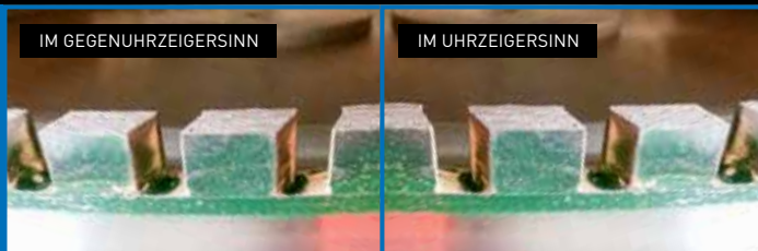
Abbildung 3 – Definition der linken Seite, links ist aus der Sicht des Werkstücks in Einlaufrichtung
